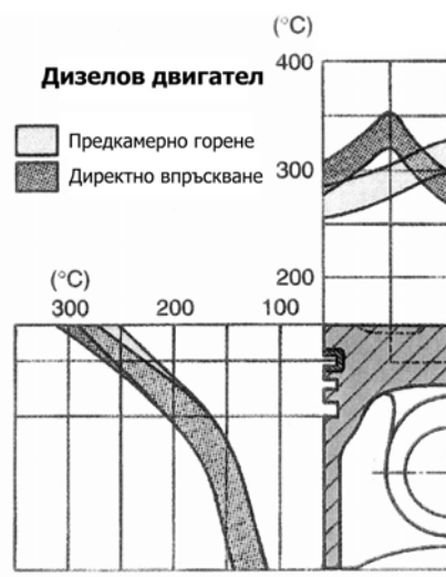
Фиг. 1. Схема на разпределението на температурата в бутала за дизелови двигатели. [1]
