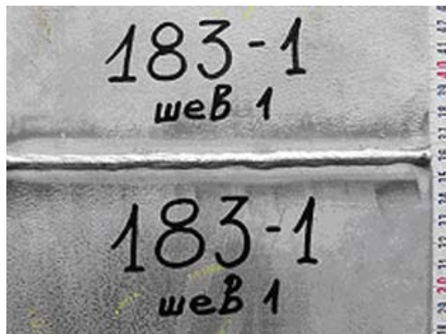
Фиг. 1. Външен вид на заварено съединение с процес 111
