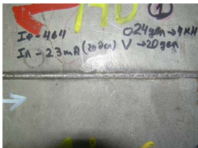
Фиг. 4. Външен вид на заварено съединение при електронно-лъчево заваряване.
