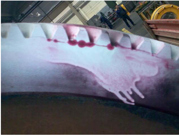
Фиг.8 Пукнатини в зъбите на полоса „долна“.
