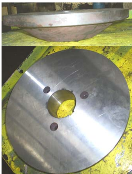
Фиг. 1 Валцов диск от стомана 9ХС.
