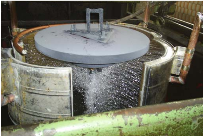
Фиг.4 Валцов диск в процес на душево охлаждане.
