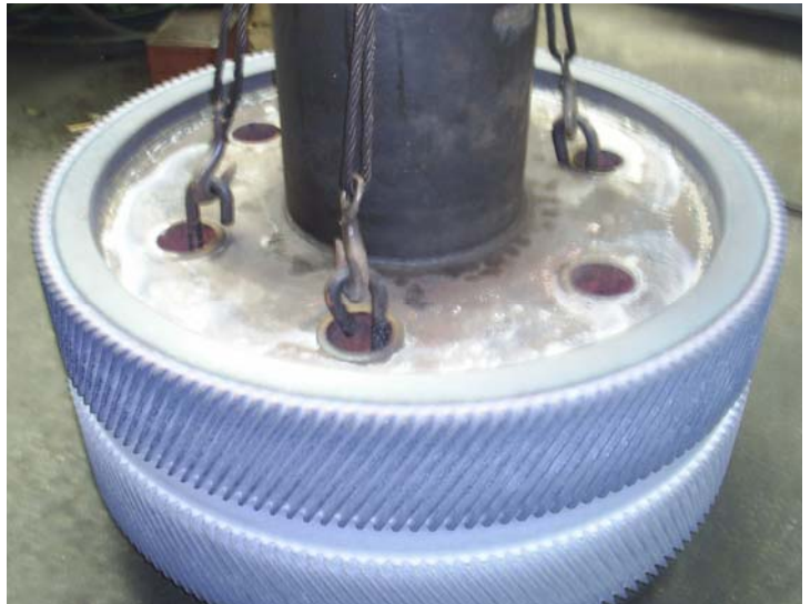
Фиг.9 Шевронно зъбно колело след дълбочинно повърхностно уякчаване.
