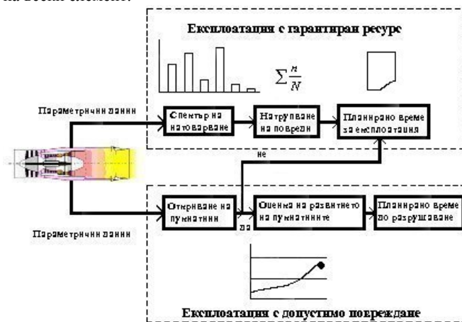
Фиг. 3. Функционална схема на обобщен подход за прогнозиране на полезния остатъчен ресурс на елементи от газотурбинни двигатели.
