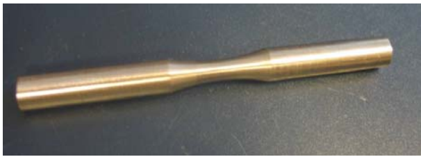
Фиг. 6. Образец (пруветка) за изпитване на умора при огъване чрез въртене (Rotating bending fatigue – RBF)
