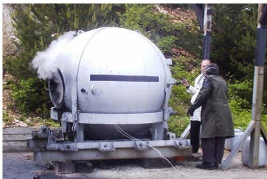
Фиг. 3. Детонационната камера за получаване на ултрадисперсен диамантен прах
