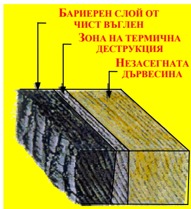
Фиг. 2. Фронт на термична деструкция – границата между зоната на термична деструкция и незасегнатата още дървесина и фронт на овъгляване – границата между произведения барьерен въгленов слой и зоната на термична деструкция.
