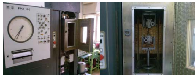
Фигура 2. Универсална машина за статични и циклични натоварвания FPZ 100
