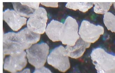
Фиг.6. Кварцов пясък H31 на фирма QUARZ WERK
