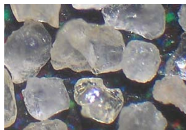
Фиг.5. Кварцов пясък LA32 на фирма SIFRACO
