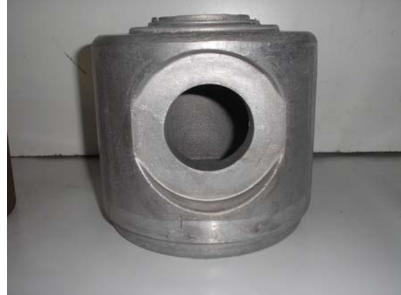
Фиг.3. Отливка “Глава”, материал AlSi7Mg, производство на Алуком АД
