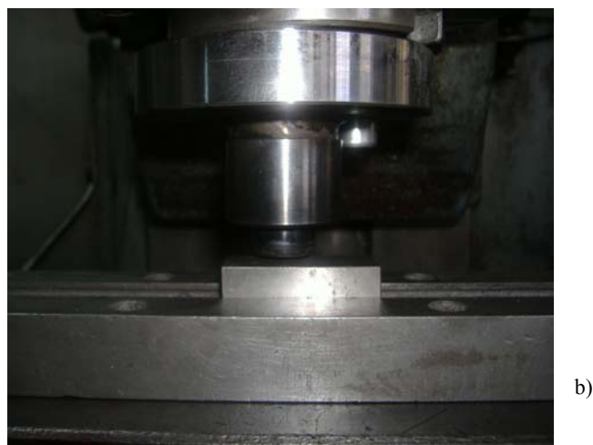
фиг.1. Схема на повърхностната пластична деформация а) общ вид, б) експериментална постановка
