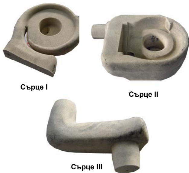
Фиг. 2 Общ вид на използваните леярски сърца
