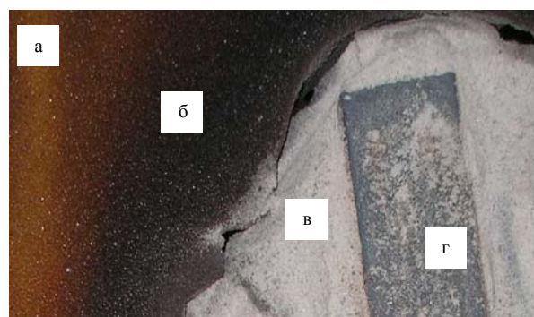
Фиг.1. Зони на деструкция на леярска форма (по Croning процес) залята при температура 1590 С 0 .
