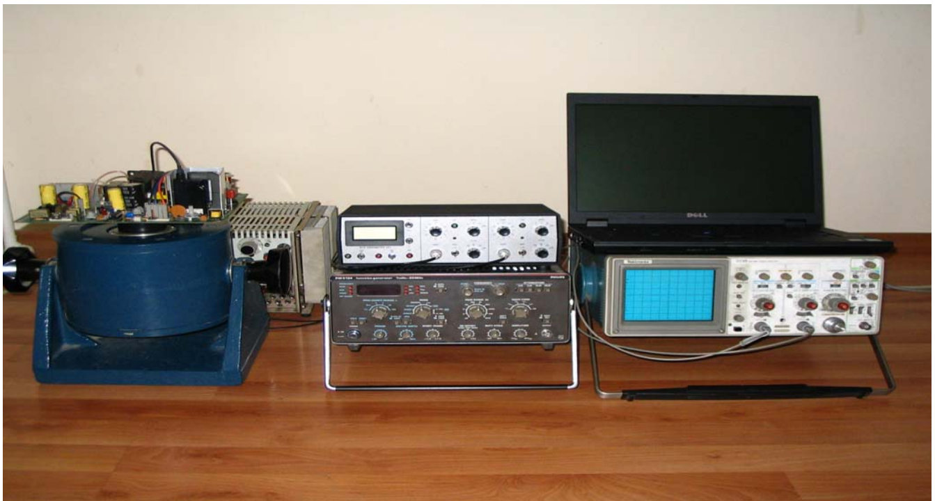
фиг. 8 Виброизпитателна система за еквивалентни изпитвания на уреди и апарати
