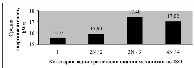
Фиг.5. Средна енергонаситеност на изпитваните трактори по категории окачни механизми
