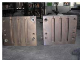
Фиг.4. ИЕ [1] за пробни тела за якост
