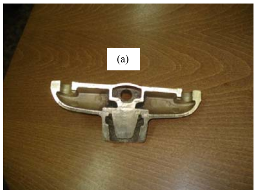
Фиг.11. Отливки (а) и (б) получени от сърца при съотношение свеж/регенериран пясък 30/70%
