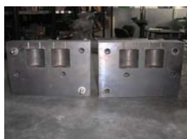
Фиг.5. ИЕ [1] за пробни тела за газопропускливост
