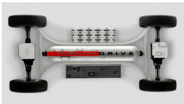
Рис.1. Шасси гибридной машины серии HySeries Drive™ - компания Ford®
