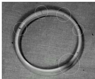
фиг. 2. Уплътнителен пръстен с четири различни по форма и дълбочина драскотини и с локална промяна в оцветяването на материала
