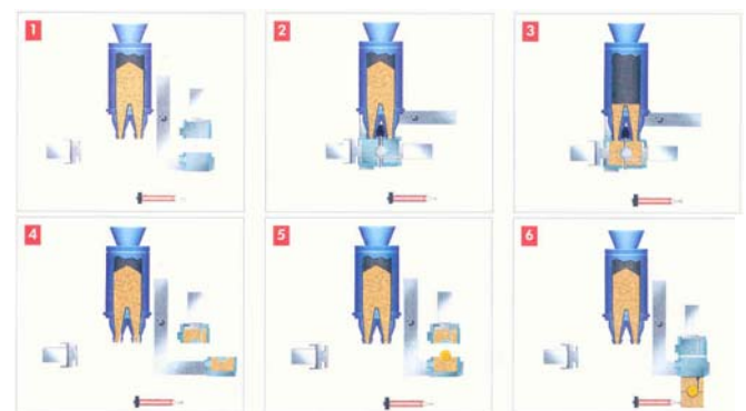
Фиг.2. Последователност при изработване на безкасови лелярски форми на машина FBO
